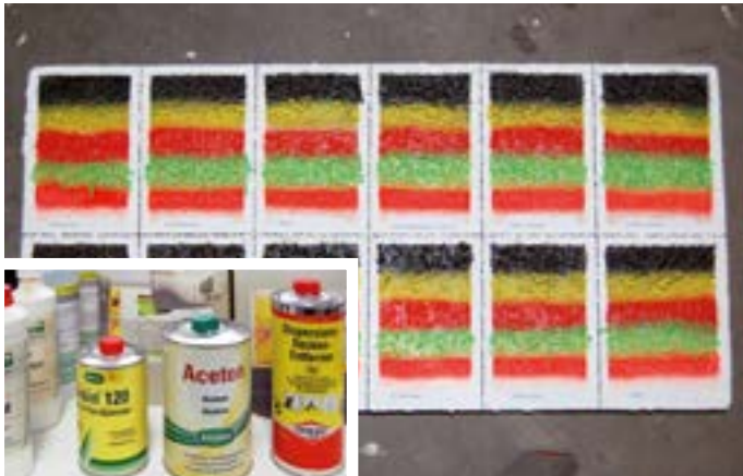
Abb. 9: Testfläche und verwendete Graffiti- und Farb-Entferner
