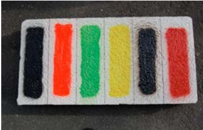
Abb.20: Sprühlackfarbe auf Anti-Graffiti-Schutzsystem
