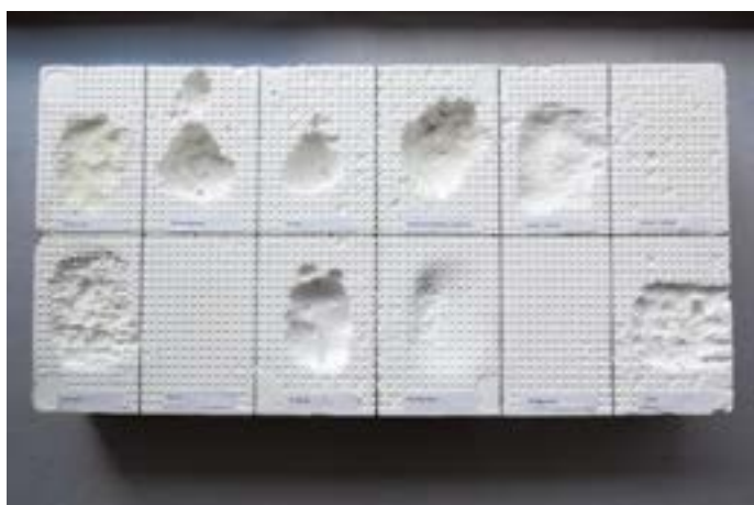
Abb. 4: Vorversuch, Graffiti-Entferner auf Polystyrol
